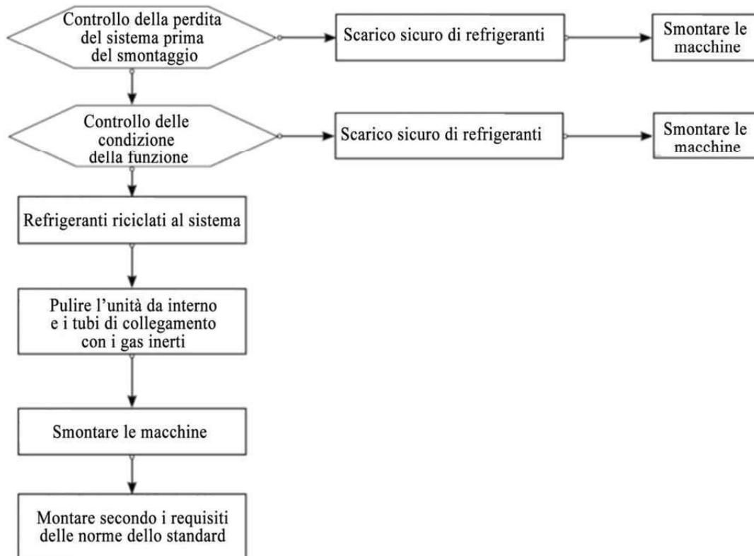
Attenzioni: Se fare lo spostamento della macchina, bisogna tagliare il giunto del tubo del collegamento fra l'aria e il liquido dell'evaporatore d'unità da interno con la fresa, rifare e ricollegarlo (il collegamento d'unità da esterno è uguale alle operazioni sopraccitate).
