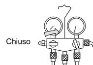
4. Aprire la valvola a stelo della valvola a 2 vie girandolo di 90 gradi in senso antiorario. Dopo 6 secondi, chiudere la valvola a 2 vie ed eseguire un'ispezione per accertarsi che non ci siano perdite di gas.
