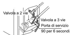
5. Non ci sono perdite di gas? Se ci sono perdite di gas, stringere i giunti del tubo. Se la perdita di arresta, procedere al punto 6. Se la perdita non si arresta, scaricare tutto il refrigerante usando la porta di servizio. Dopo avere attivato di nuovo il degassamento ed aspirato l'aria, riempire con refrigerante raccomandato usando la bombola del gas.
