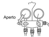
3. Aspirare sottovuoto per più di 15 min, Controllare l'indicatore che deve indicare -0.1MPa (76 cm Hg) sul lato della bassa pressione. Dopo avere completato la procedura di scarico, chiudere la manopola in posizione "Lo" del gruppo manometrico ed arrestare il funzionamento della pompa a vuoto. Controlla le condizioni della scala graduata e tenerla per 1-2 min. Se l'indicatore si sposta, malgrado la chiusura, far funzionare di nuovo il degassamento e tornare al principio del punto 3 .
