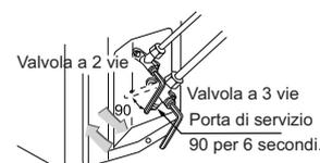
5. Non ci sono perdite di gas? Se ci sono perdite di gas, stringere i giunti del tubo. Se la perdita di arresta, procedere al punto 6. Se la perdita non si arresta, scaricare tutto il refrigerante usando la porta di servizio. Dopo avere attivato di nuovo il degassamento ed aspirato l'aria, riempire con refrigerante raccomandato usando la bombola del gas.
