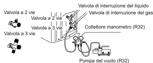
2. Aprire a livello basso la manopola del gruppo monometrico, operare la pompa a vuoto. Se l'indicatore (basso) raggiunge la condizione di vuoto immediatamente, controllare di nuovo il punto 1.
