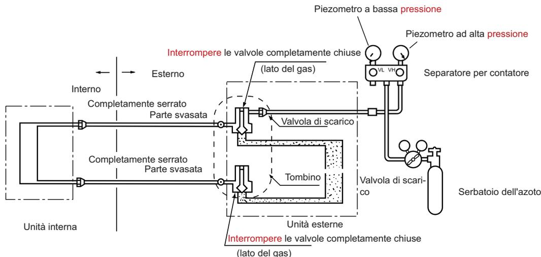
1) Mettere sotto pressione per più di 3 minuti a 0,3 MPa (3,0 kg/cm<sup>2</sup>g)
