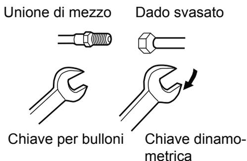
Un serraggio eccessivo senza eseguire una centratura accurata può danneggiare le filettature e provocare perdite di gas.
